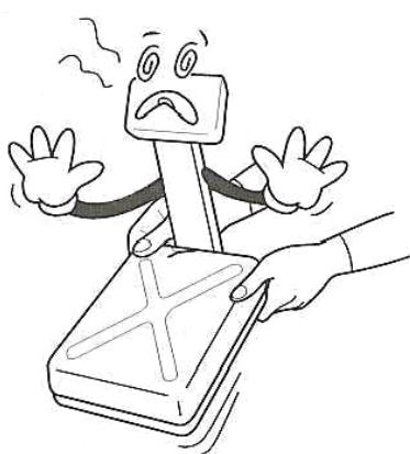
Nevystavujte váhu intenzivnímu proudění vzduchu (například z ventilátoru) ani vibracím – znemožňuje to ustálení váhy a tím dochází i ke snížení přesnosti.
