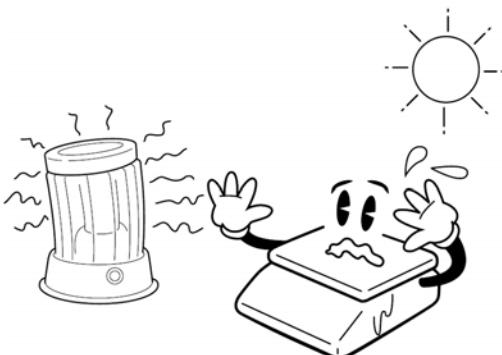
Nevystavujte váhu náhlým změnám teplot ani dlouhodobému přímému působení slunce nebo jiných zdrojů intenzivního tepelného záření. Pokud váhu přemístíte z venkovního prostředí, doporučuje se zapnout váhu 15 až 30 minut před použitím pro důkladnou temperaci.
